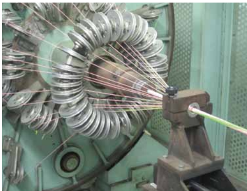
光ファイバケーブル製造ライン
