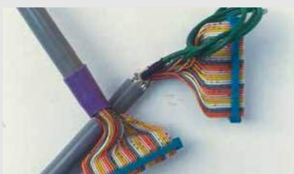
インターフェースケーブルのコネクター接続部 (NPE)
