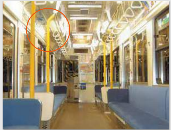
路面電車の握り棒カバー(ノンハロ難燃仕様)(NON)
